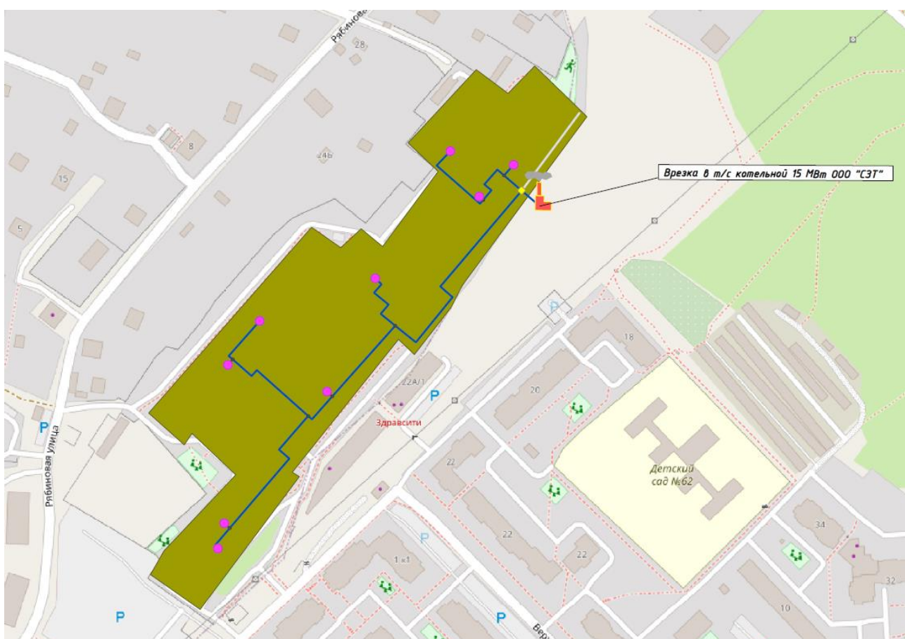
Рисунок 17. Зона действия и тепловые сети котельной 15 МВт ООО «СЗТ»
