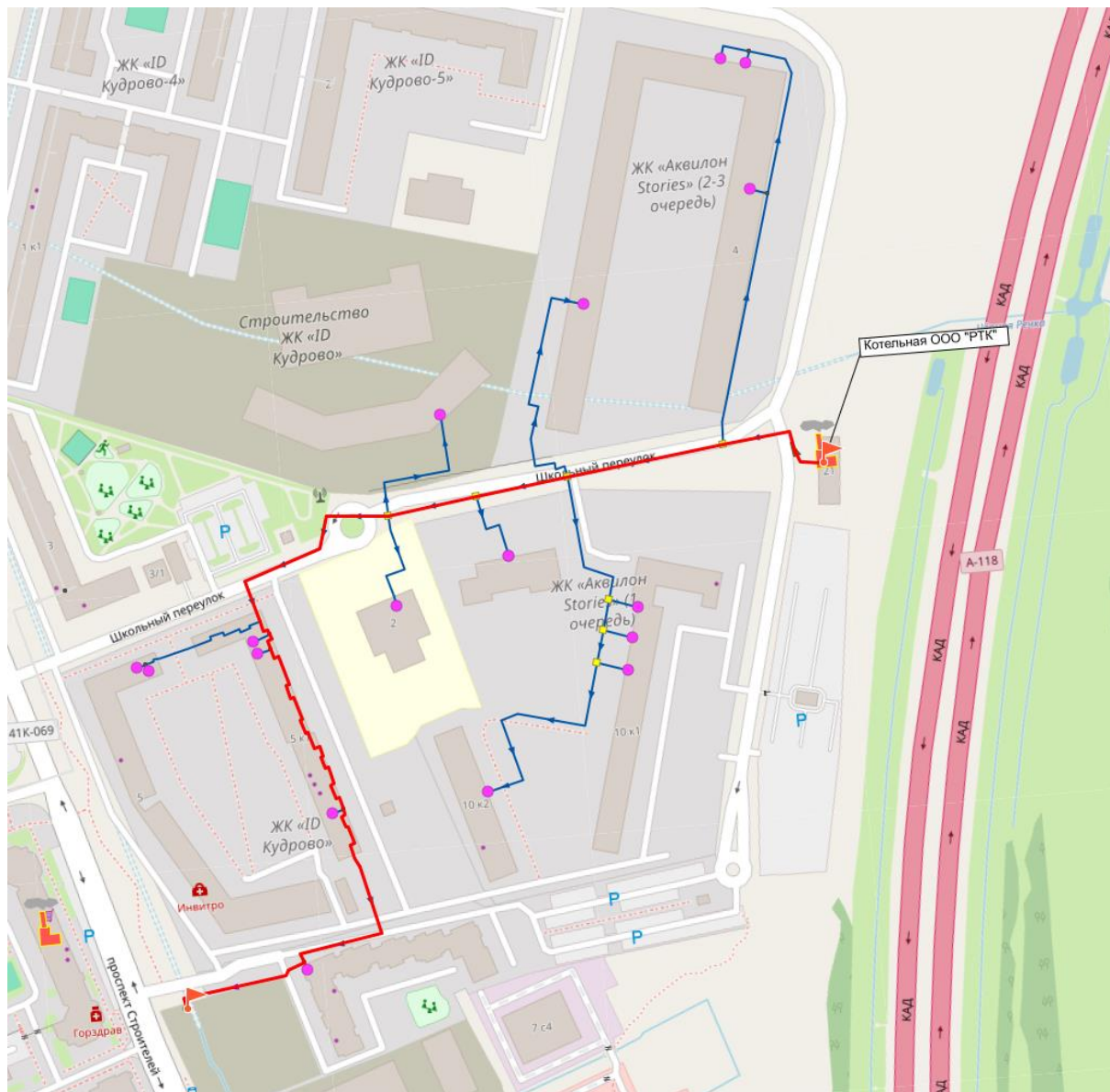
Рисунок 6. Путь построения пьезометрического графика от котельной ООО «РТК» до перспективного потребителя- ТК
