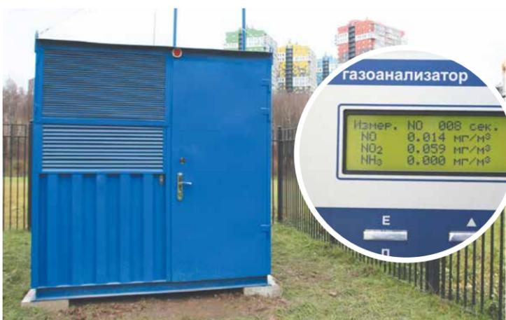
Сооружения, расположенные возле поликлиники и муниципального стадиона предназначены для сбора данных по содержанию аммиака, сероводорода, оксидов и диоксидов азота, оксидов углерода, диоксидов серы. Кроме того, они позволяют измерять общую концентрацию пыли и исследовать ее фракции. Все это является базовыми показателями.
