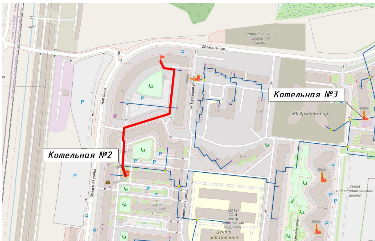
Рисунок 34. Путь построения пьезометрического графика от котельной ООО «Энергия» №2 до потребителя по ул. Областная, 3.
