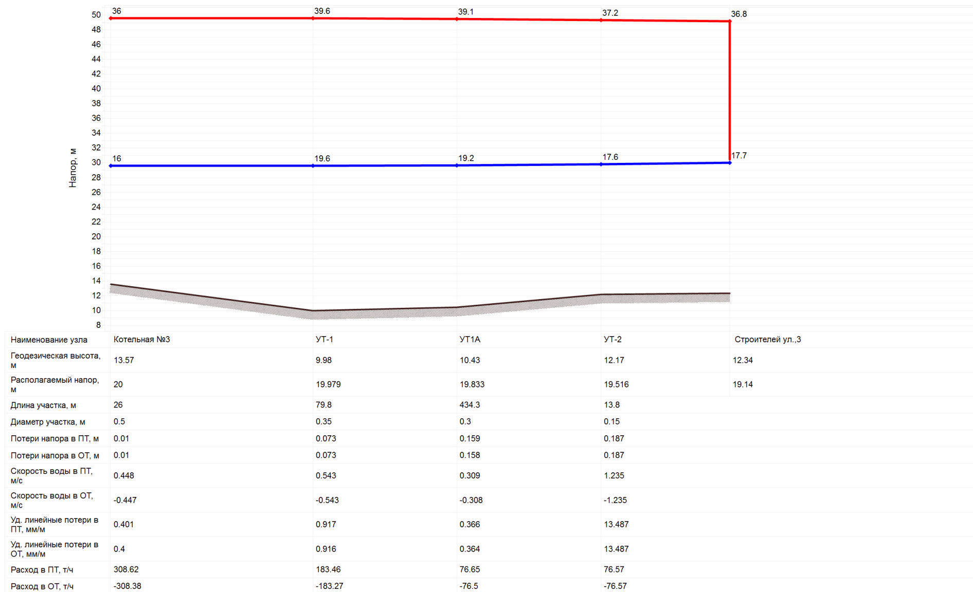
Рисунок 37. Пьезометрический график от котельной ООО «Энегрия» №3 до потребителя по ул. Строителей,3
