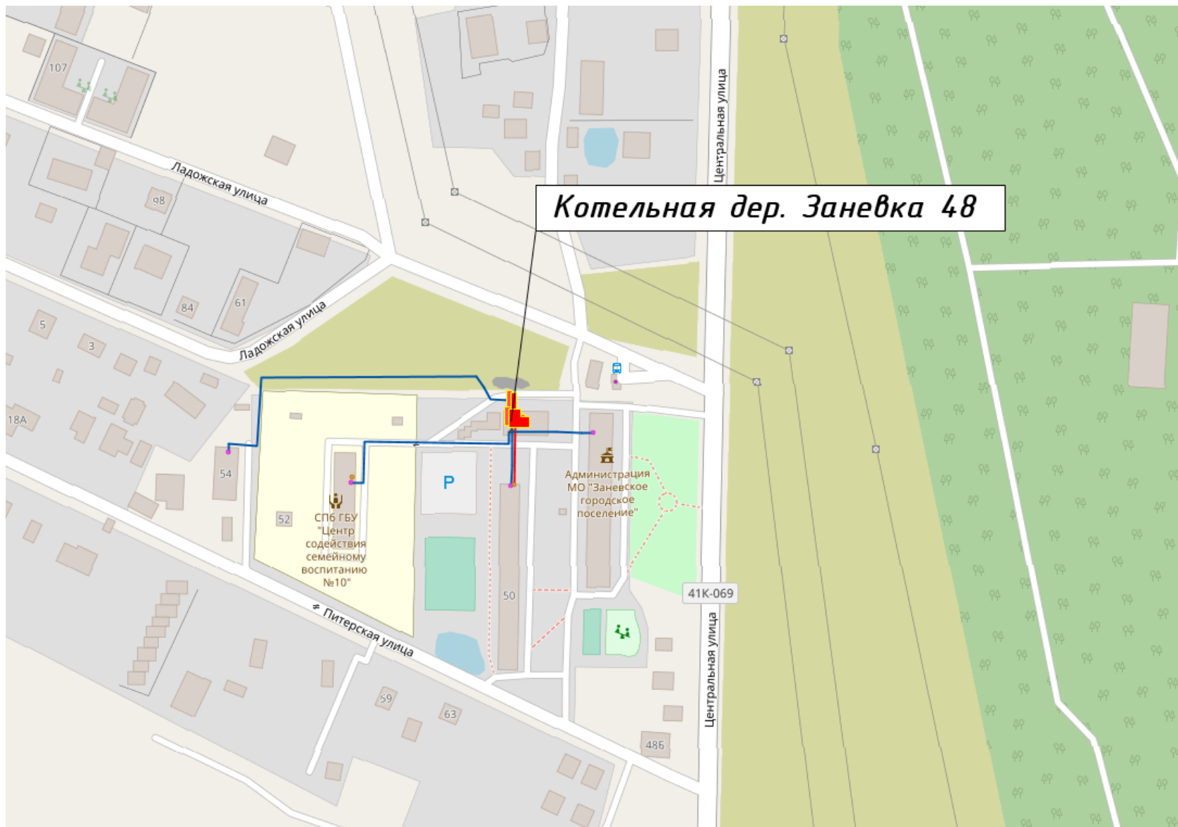
Рисунок 2. Схема тепловых сетей котельной ГУП «ТЭК СПб», Заневка 48
