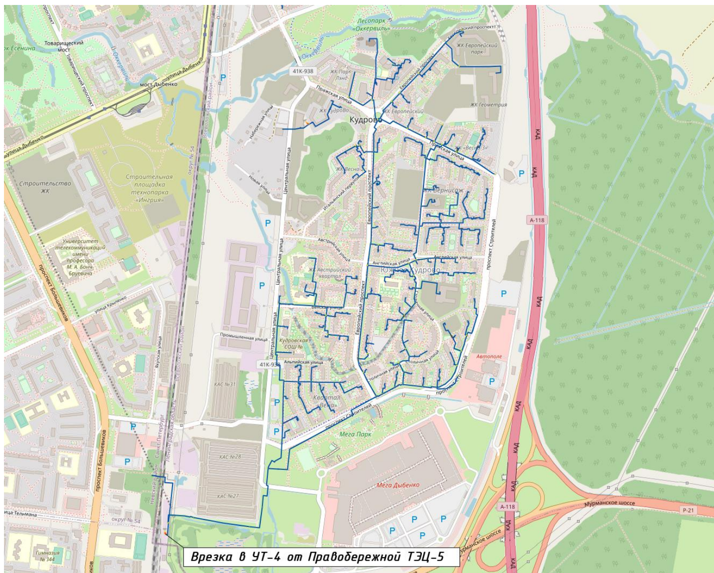
Рисунок 4. Схема тепловых сетей АО «Теплосеть СПб» от ТЭЦ-5 филиала «Невский» ПАО «ТГК-1»
