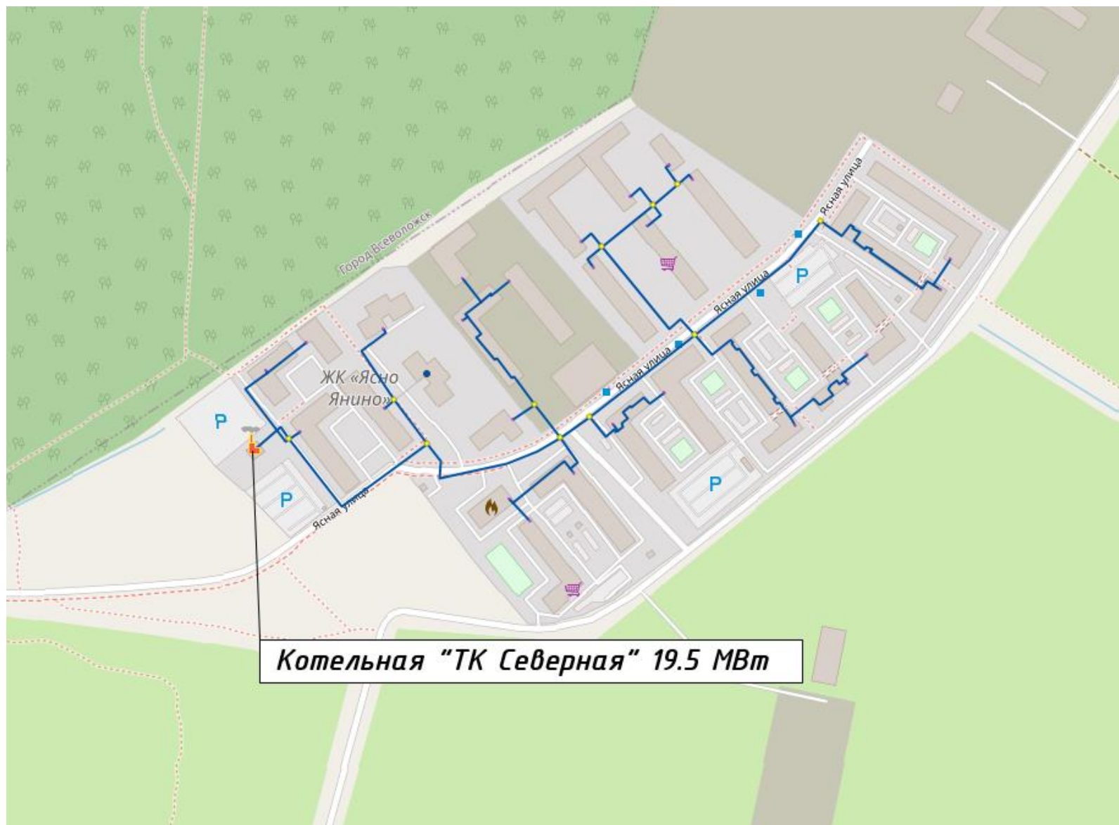
Рисунок 6. Схема тепловых сетей котельной 19,5 МВт ООО «ТК Северная»
