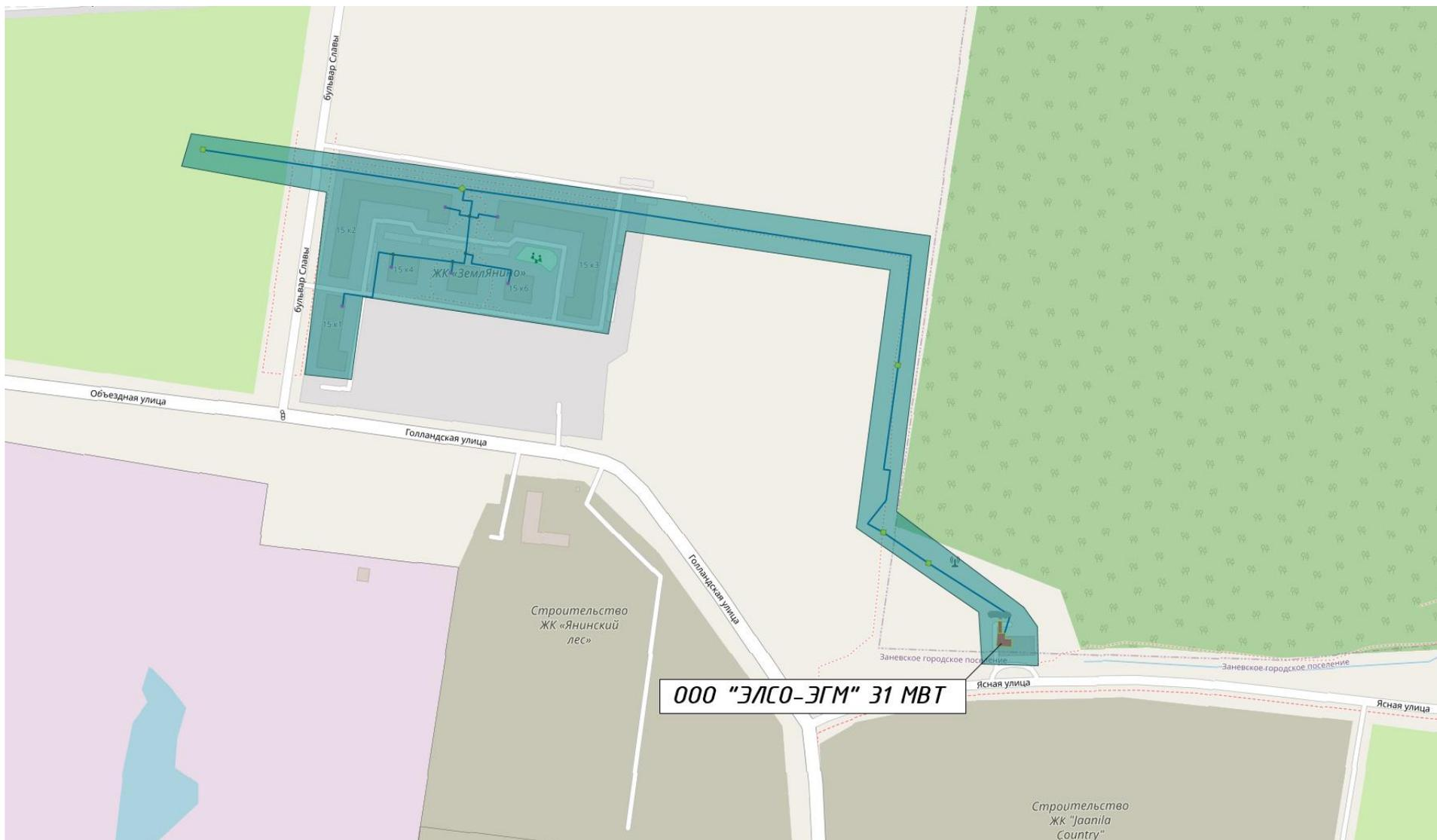
Рисунок 20. Зона действия и тепловые сети котельной 31МВт ООО «ЭЛСО-ЭГМ»
