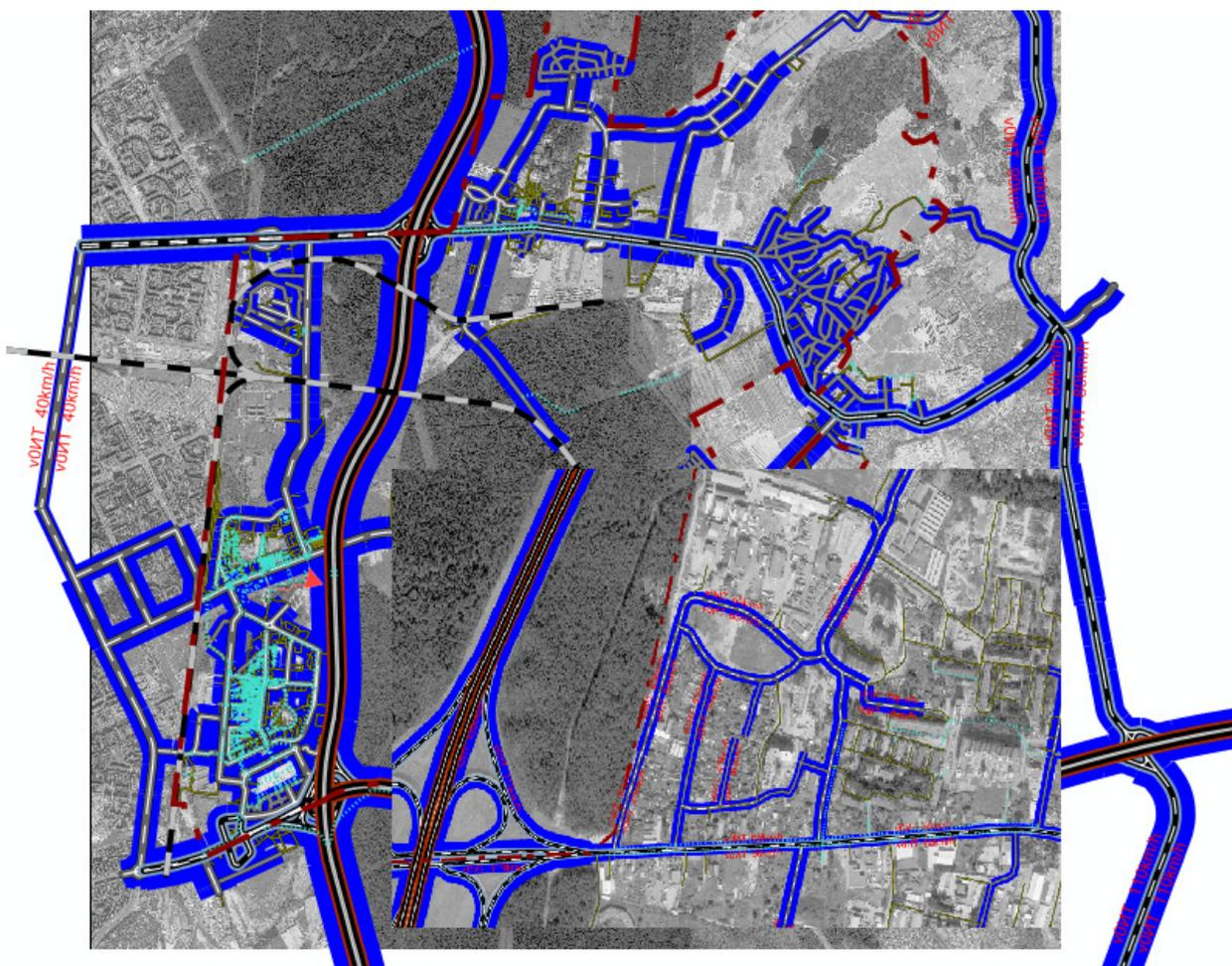
РИСУНОК 51 КАРТОГРАММА РАСЧЁТНЫХ СКОРОСТЕЙ ДВИЖЕНИЯ
