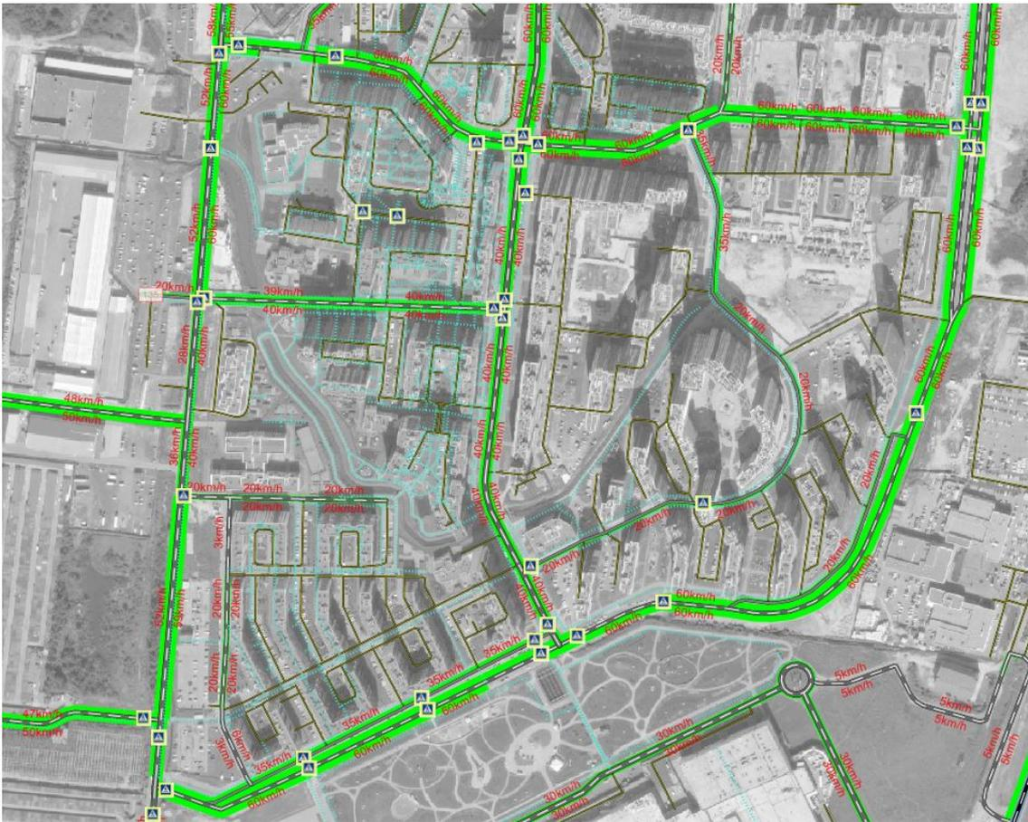
**РИСУНОК 52 ФРАГМЕНТ КАРТОГРАММЫ МАКСИМАЛЬНЫХ БЕЗОПАСНЫХ СКОРОСТЕЙ ДВИЖЕНИЯ УЛИЧНО-ДОРОЖНОЙ СЕТИ**
