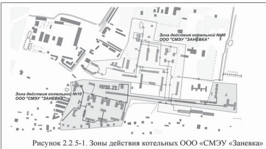
Рисунок 2.2.5-1. Зоны действия котельных ООО «СМЭУ «Заневка»
